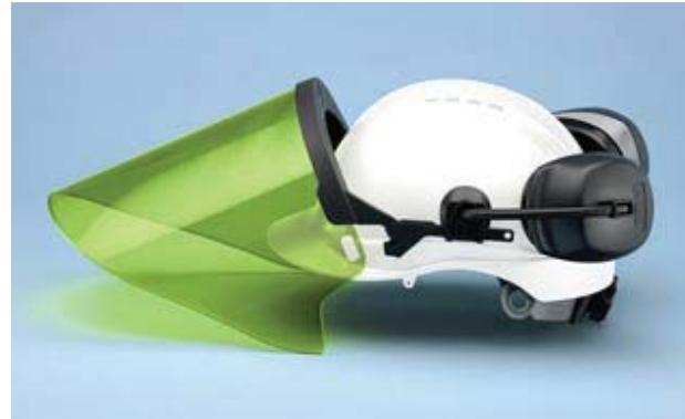
ماسک صورت بایستی از جنس طلق پلی کربنات بوده و درای قابلیت تحمل دمای انرژی از ۸ تا ۴۰ کالری بر سانتیمتر مربع را بسته به میزان HRC محاسبه شده مطابق با بند ( ۳-۲-۶ ) داشته باشد . جهت جلوگیری از خش دار و کدر شدن طلق ماسک بایستی پس از استفاده داخل کاور محافظت قرار داده شود .
